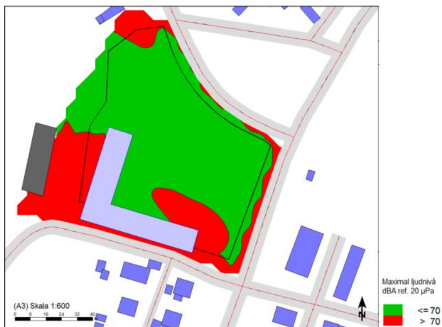
Figur 8. Maximala ljudnivåer på förskolegården med en kombination av bullerskyddsåtgärder. De ytor som uppfyller riktvärdet för både ekvivalent- och maximal ljudnivå sammanfaller inte helt med varandra. Beräkningarna visar att en yta på ca 4000 m 2 uppfyller riktvärdet för både ekvivalent- och maximal ljudnivå vilket motsvarar ca 70 procent av förskolegården. Detta innebär att lokalförvaltningens ljudkrav på att minst 80 procent av förskolegårdens yta ska ha en ekvivalent- och maximal ljudnivå på högst 50 respektive 70 dBA inte uppfylls.
